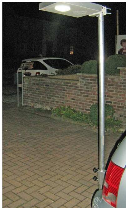
Pfiffig gemacht: Licht-Set CS 208 als mobile Arbeitsplatzbeleuchtung an einen ausfahrbaren Mast auf einer Anhängerkupplung montiert
